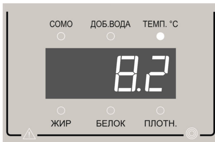
Рисунок 2.13 – Настройка порога СОМО, контрольное значение СОМО 8,20
