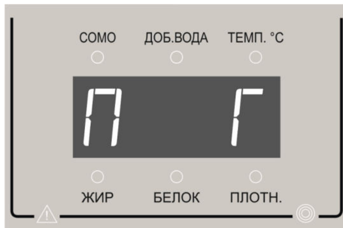
Рисунок 2.12 – Анализатор находится в режиме подкалибровки.
