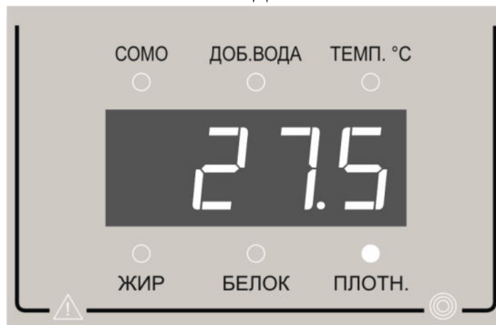
Рисунок 2.9 – Плотность молока 27,5 в градусах ареометра (1027,5 кг/м 3 )
